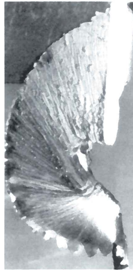
Bild 2: Scheinspanbildung beim Drehen von Aluminium
