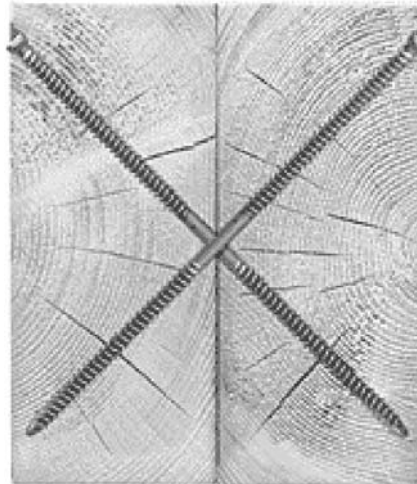
Bild 7.32: Verbindung von Koppelfetten mittels Spezialschrauben mit Doppelgewinde
