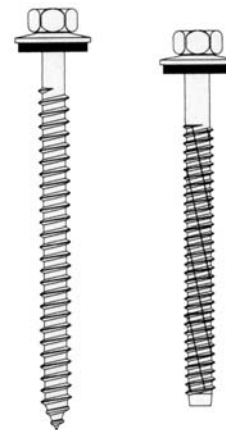
Bild 7.24: Gewindeformen (Grobgewinde, Feingewinde)
