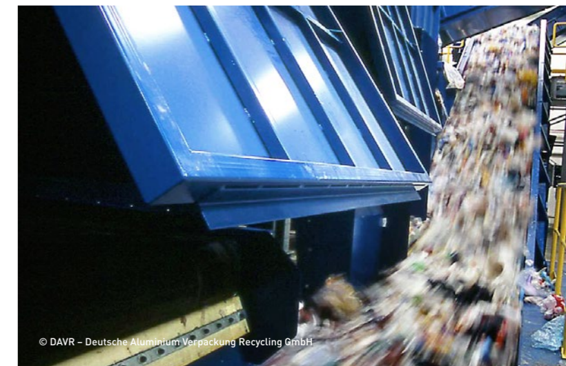
In modernen Sortieranlagen wird das gesammelte Material in die einzelnen Wertstoffgruppen getrennt.
