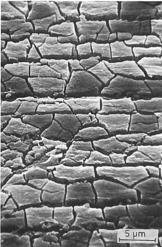
Bild 1: Gelbchromatierschicht (Bonder Al 723) auf Aluminium, aufgenommen mit Rasterelektronenmikroskop (Werkbild Metallgesellschaft AG, Frankfurt)
