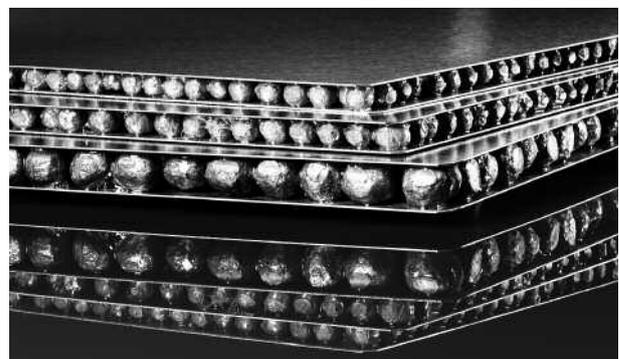
APM-Sandwich (Foto: Fraunhofer-IFAM Bremen) (Bild 33)
