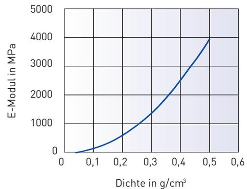
E-Modul von schmelzmetallurgisch erzeugtem Aluminiumschaum in Abhängigkeit von der Dichte (Norsk-Hydro, nach Åsholt)
