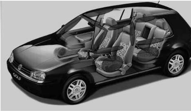
Die gekennzeichneten Polsterbereiche federn bei einem Seitencrash die Energie des Aufpralls ab. Ziel ist es, unterschiedliche Materialien exakt dort einzusetzen, wo sie mit ihren Eigenschaften eine optimale Wirkung erzielen – eine Chance für Aluminiumschaum (Foto: Volkswagen) (Bild 72)
