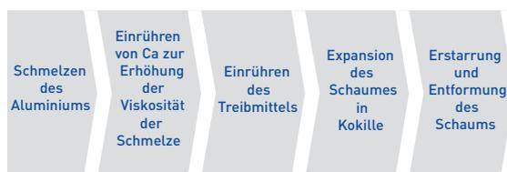
Verfahrensprinzip des ALPORAS-Verfahrens - direktes Aufschäumen von Schmelzen mittels Treibmittel (nach Miyoshi) (Bild 7)
