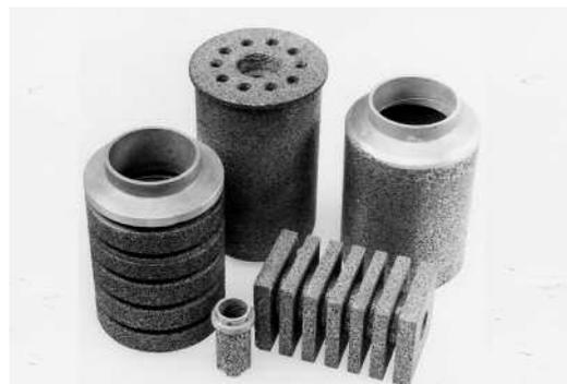
Beispiele für Bauteilformen aus offenerporigem Aluminiumschaum (Foto: Banhart) (Bild 81)
