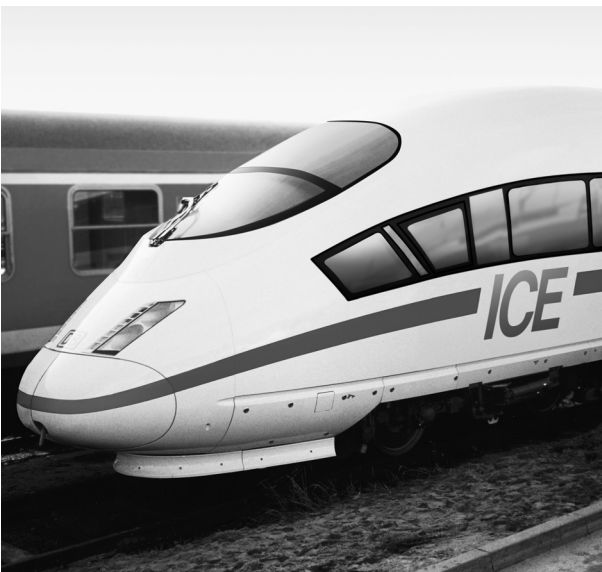
Die ICE-Mittelwagen sind aus bis zu 800 mm breiten und über 23 m langen Aluminium-Strangpressprofilen geschweißt.
