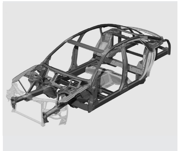
Aluminium-Space-Frame (ASF) als Tragstruktur der Ganzaluminium-Karosserie für das Serienautomobil
