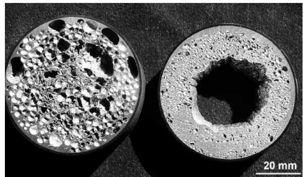
Rotierendes Aufschäumen ergibt feine Poren und eine gradierte Struktur (rechts im Bild), links ohne Rotation. (Foto: IOT, RWTH Aachen) (Bild 35)
