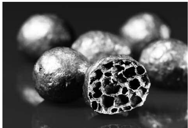
Querschnitt eines einzelnen Schaumelementes (Foto: Fraunhofer-IFAM Bremen) (Bild 29)
