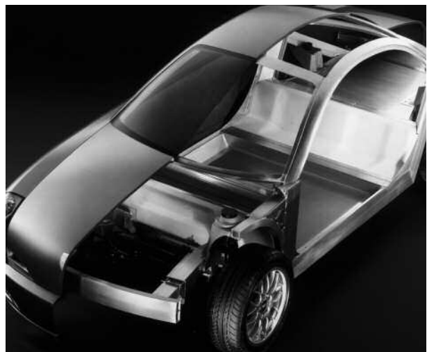
Konzeptstudie AFB – Fahrzeugkarosserie mit eingesetzten Teilen aus Aluminiumschaum (Foto: Karmann) (Bild 74)
