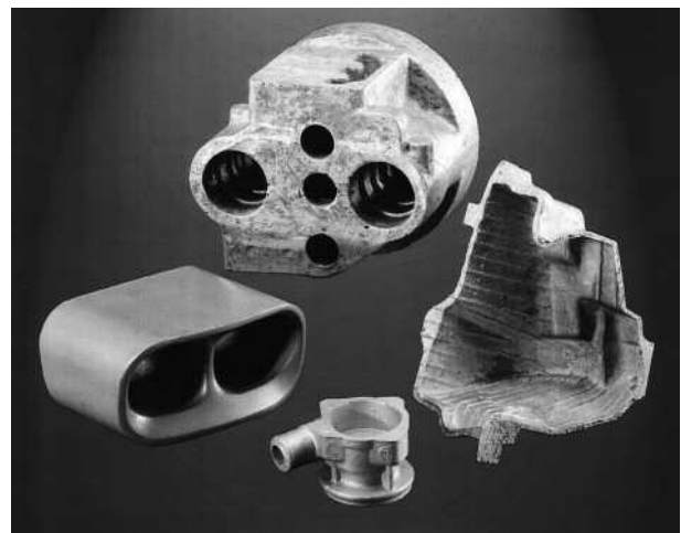
Aluminiumschaumformteile, hergestellt über einen Gießprozess (Neumann Alu Foam, Marktl, Österreich) (Bild 26)
