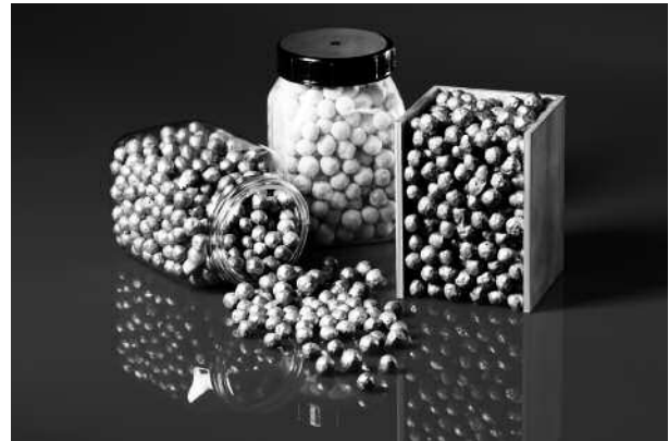
APM-Elemente (Mitte: Klebstoff beschichtet) und gefüllte Hohlstruktur (Foto: Fraunhofer-IFAM Bremen) (Bild 28)
