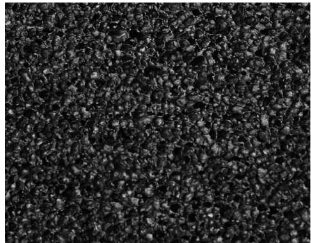
Struktur eines geschlossenenporigen Schaums (Foto: Metall) (Bild 11a)
