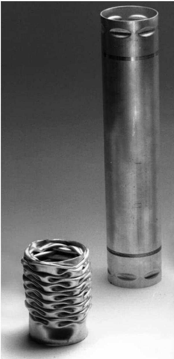
Crashrohr aus Aluminium – Verdeutlichung des Verformungsverhaltens „Faltenbeulen“ (Bild: VW) (Bild 55)
